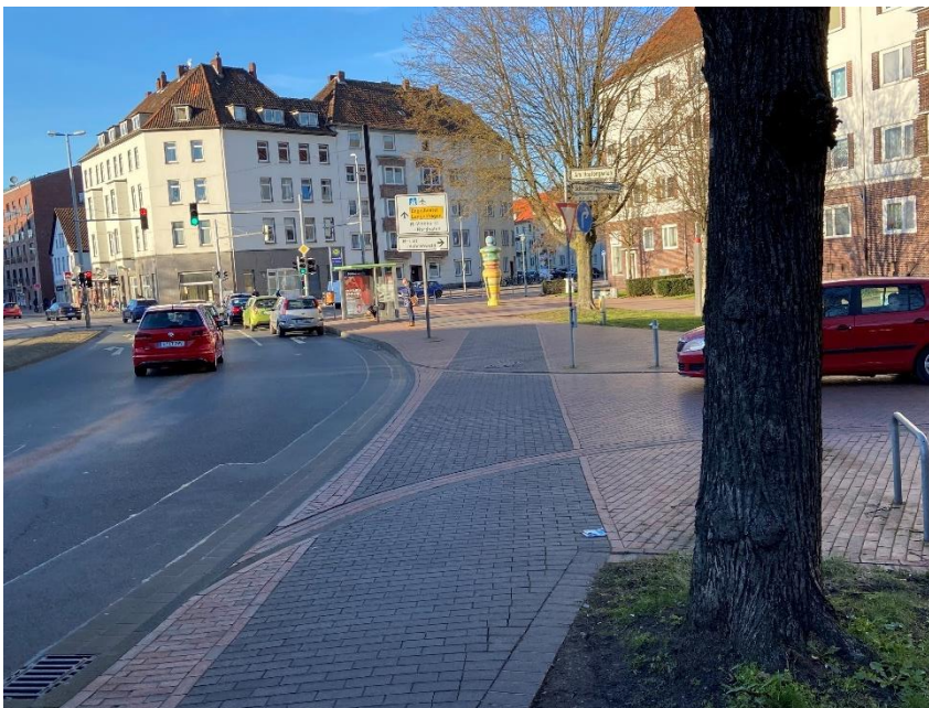
Abbildung 18: Aufpflasterung Am Hopfengarten
